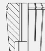
Per pinze con foro interno scaricato, utilizzare il settaggio Torque "MIN"
