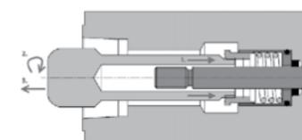
Svitare il perno e rimuoverlo dalla boccola, verificare la funzionalità della stessa premendoci sopra.
