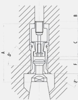
**PINZA A BLOCCAGGIO AUTOMATICO
