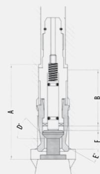
**PINZA A BLOCCAGGIO AUTOMATICO
