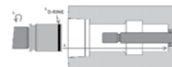
Inserire la boccola come evidenziato in figura prestando attenzione che l'o-ring sia montato nella parte anteriore.
