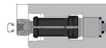
Una volta compresso il gruppo di petali contro il tirante, mandare l'espulsore utensile in fase di sgancio ed avvitare la pinza sul tirante e regolarne la corsa.
