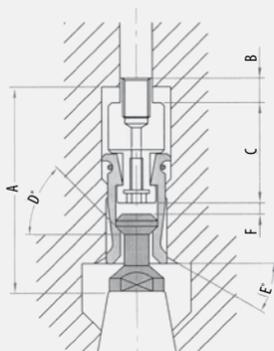
**PINZA A BLOCCAGGIO AUTOMATICO
